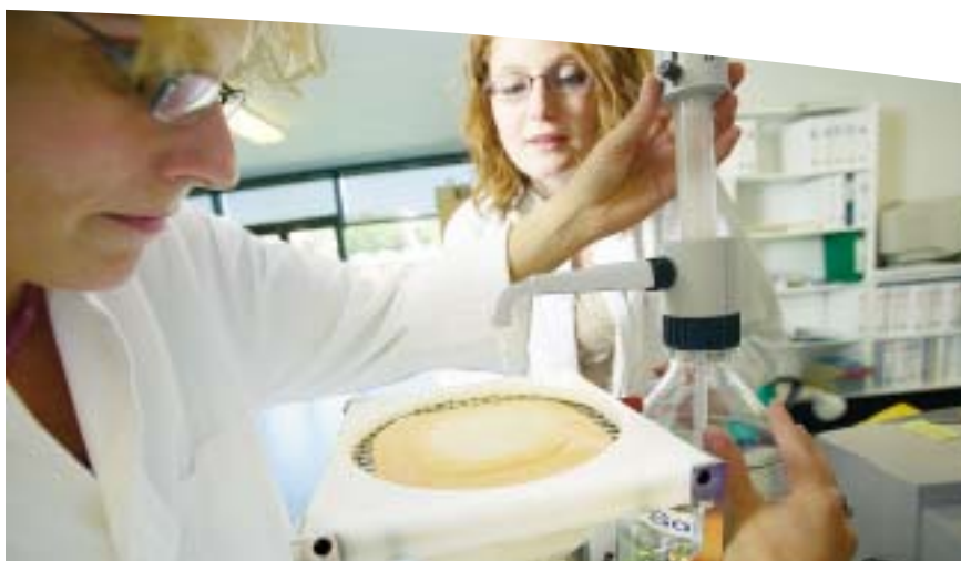
▼ Projektleder Mette Irene Kolte (th) og laborant Rikke Marie Torpe ved det laboratorieudstyr, der bruges til måling af sugeevne.
